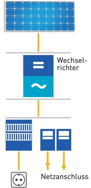
Der Wechselrichter wandelt den vom Solargenerator produzierten Gleichstrom (DC) in Wechselstrom (AC) um, damit er in ein vorgegebenes Netz eingespeist werden kann.
