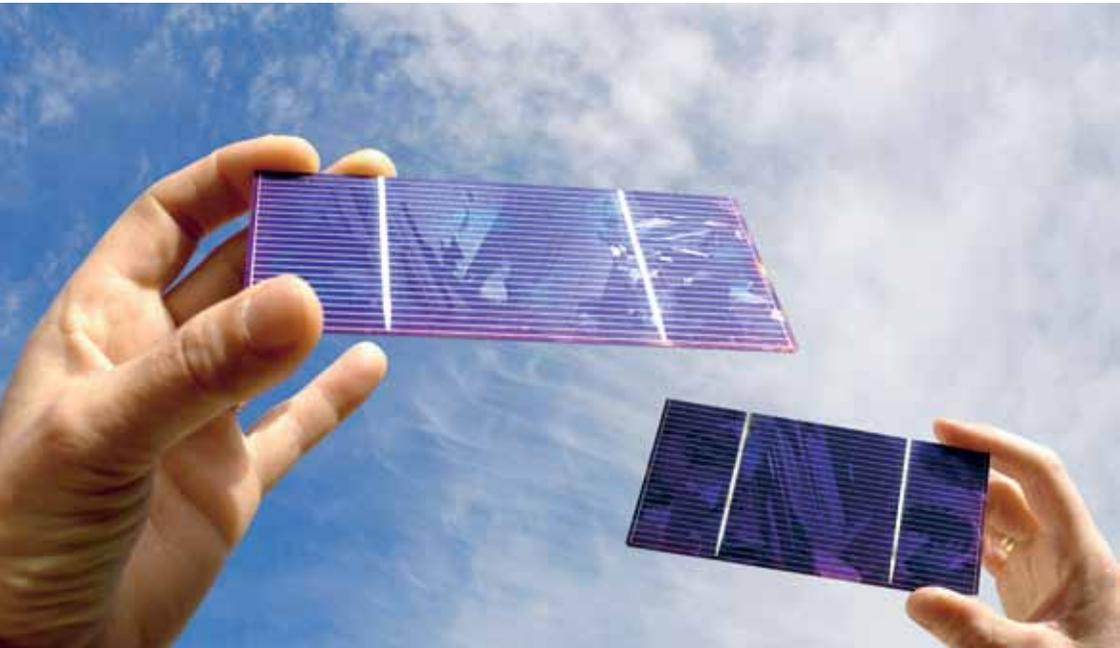
Da der Glasverbund von PV-Modulen aus gehärtetem Glas besteht, ist beim Umgang mit ungerahmten Modulen darauf zu achten, dass die Glaskanten nicht belastet werden. Eine winzige Beschädigung der Glaskante führt früher oder später unweigerlich zum Zerspringen des Glases. Gerahmte Module sind dagegen wesentlich unproblematischer zu transportieren und zu montieren.
